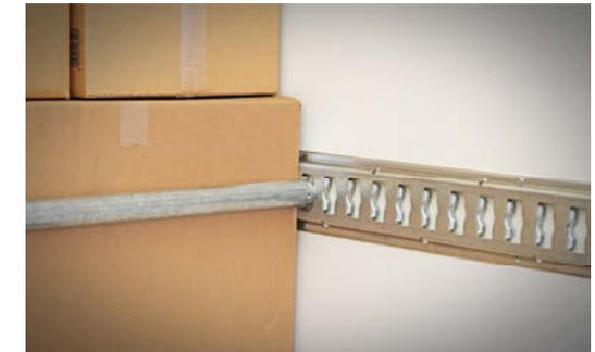
Horizontale Ladungssicherung mit Sperrstangen und Kombiankerschiene
