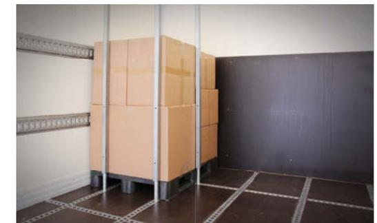
Vertikale Ladungssicherung mit Lochschiene im Boden und unter dem Dach
