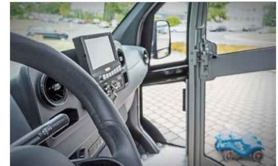
SP45plus: beifahrerseitige Fensterelemente für eine optimale Verkehrssicherheit
