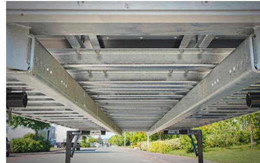
Solide verzinkte Unterbaukonstruktion
