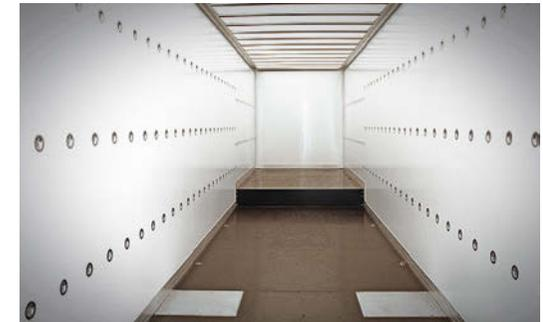
Zwei-Achs-Stufensattelanhänger mit einteiligem lichtdurchlässigen Dach und flächenbündig eingelassenen Zurrmulden
