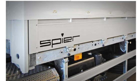
Curtainsider mit Bordwänden und Verschlusssystem "Quick Slide"
