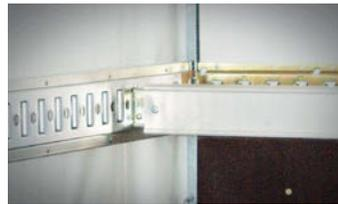
Einstecklatten mit Kombiankerschienen und Absperrbalken
