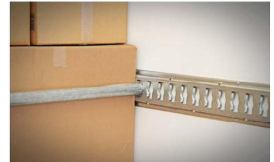
Horizontale Ladungssicherung mit Sperrstangen und Kombiankerschiene
