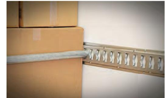
Horizontale Ladungssicherung mit Sperrstangen und Kombiankerschiene
