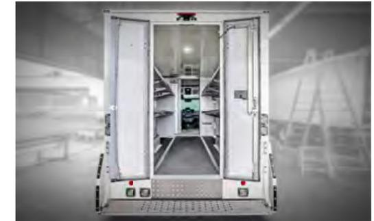
Markantes Heck des SP60plus mit zweiflügeliger Hecktür, gelenkschonendem Hecktritt und ca. 17 m<sup>3</sup> Laderaumvolumen
