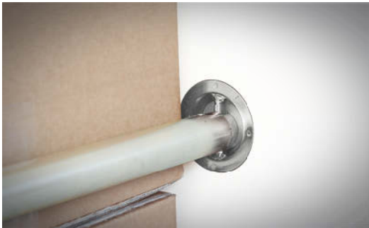
Ladungssicherung mit SPIER Zurrmulden und Absperrstangen
