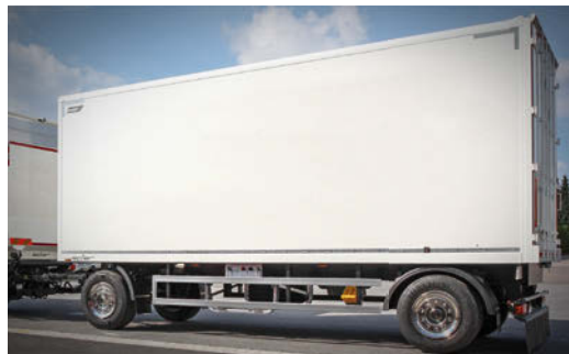
Drehschemel- oder Zentralachsanhänger mit Athlet Kofferaufbau
