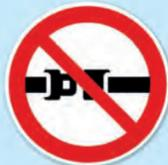
Einzel-Zurrgurt auf der Zurrschiene:.....LC 150 daN
